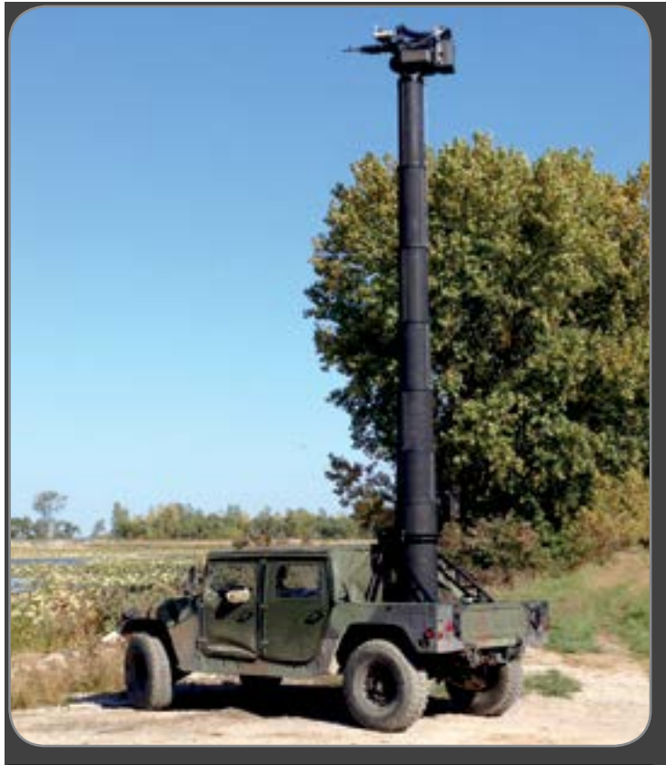
Рабочий диапазон мачты VELOCIRAPTOR : выдвинута: 6 М, нагрузка: 100 КГ
