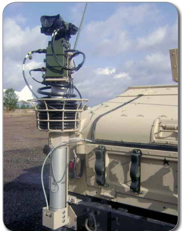
SYSTEME DE TILT POUR MAT STILETTO ICI AVEC UN MAT STILETTO 4 M HD
